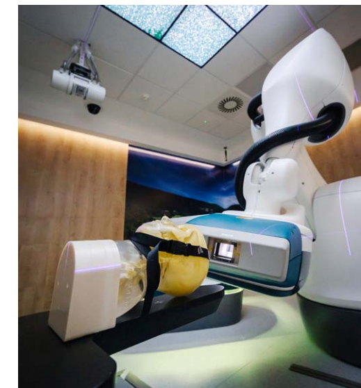
Testování nového zařízení probíhalo i na napodobeninách lidského těla, tzv. fantomech.
